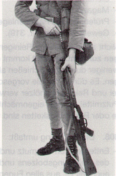
Durchziehen des Rohrs mit Reinigungskette und Docht
